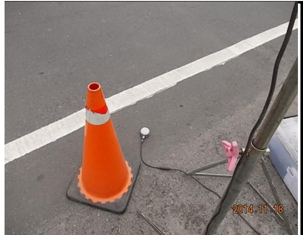
安西府(振動監測情形)
