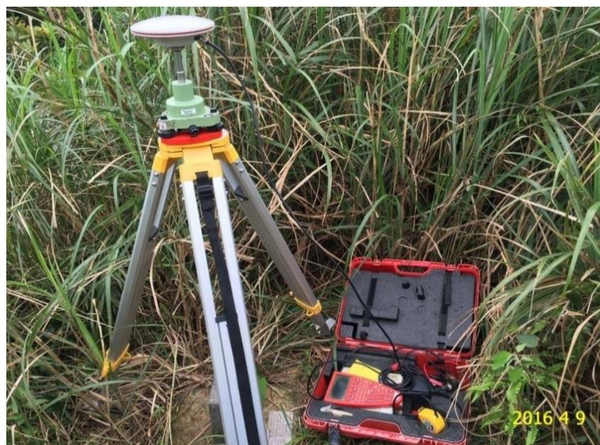
圖 3-2 監測區控制點測量圖
