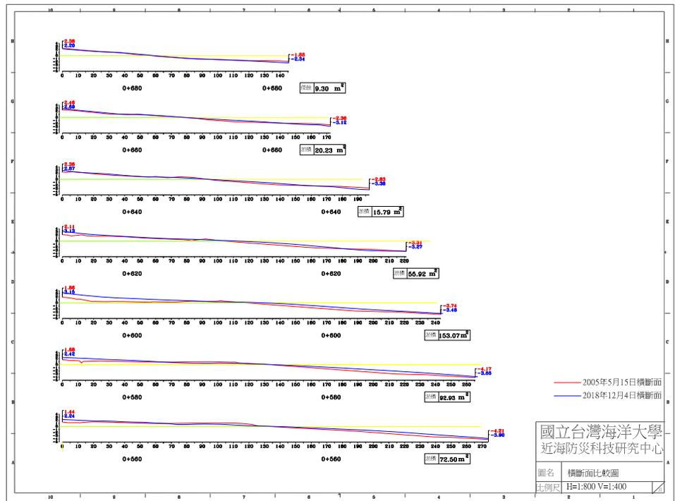
圖 4-5(b) 2018 年 12 月 7 日 B 監測區橫斷面比較圖
