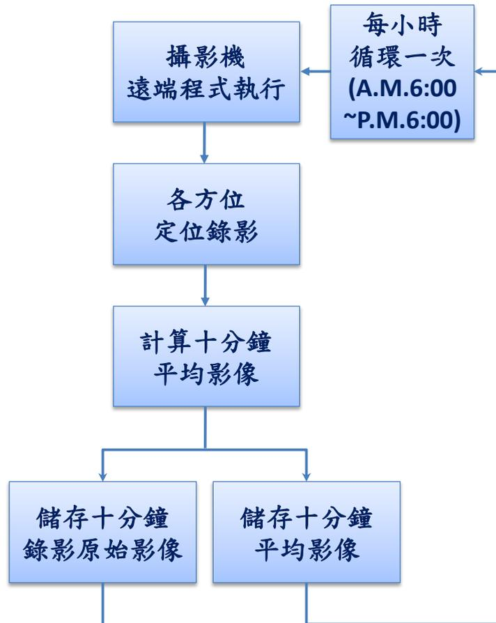
圖 3-17 影像觀測系統程式執行流程圖
