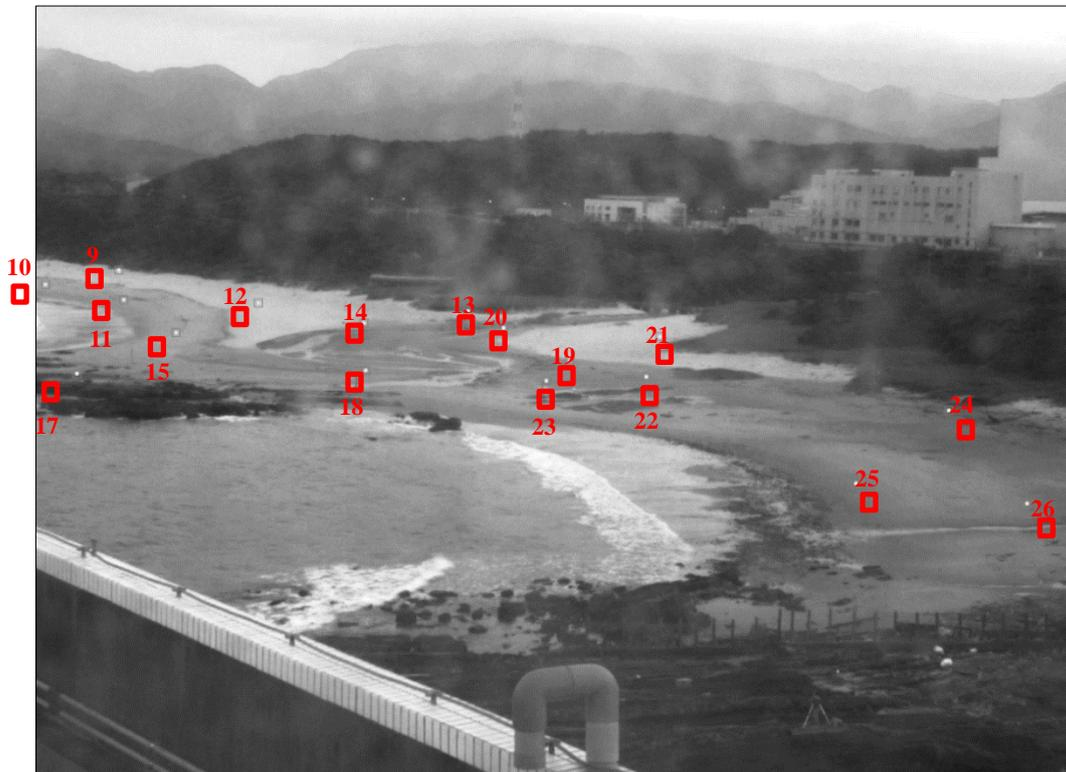
圖 3-21 視角 1(Cam1)地面控制點位置分佈圖例
