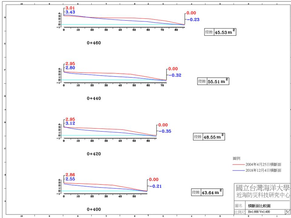
圖 4-4(e) 2018 年 12 月 7 日 A 監測區橫斷面比較圖
