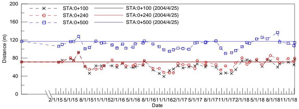
圖 4-21 岸線斷面沙灘寬度變化圖(斷面編號：0+100、0+240、0+500)
