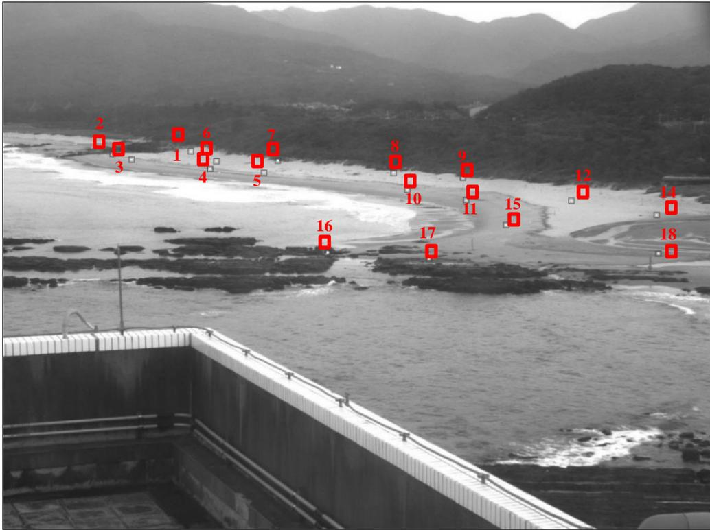
圖 3-20 視角 2(Cam2)地面控制點位置分佈圖例
