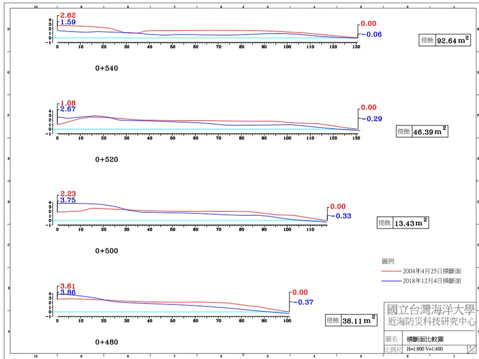
圖 4-4(d) 2018 年 12 月 7 日 A 監測區橫斷面比較圖
