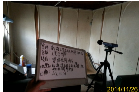
照片 1.3-12 全頻及低頻營建工程噪音 【彰濱工業區聯外跨海大橋工業側工區周界】
