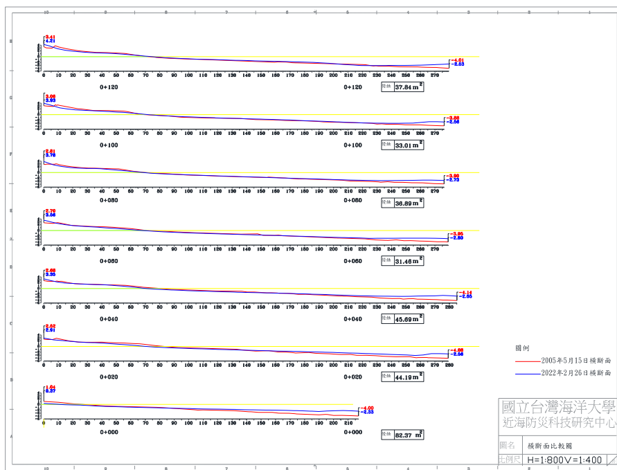
圖 4-5(f) 2022 年 2 月 26 日 B 監測區橫断面比較圖
