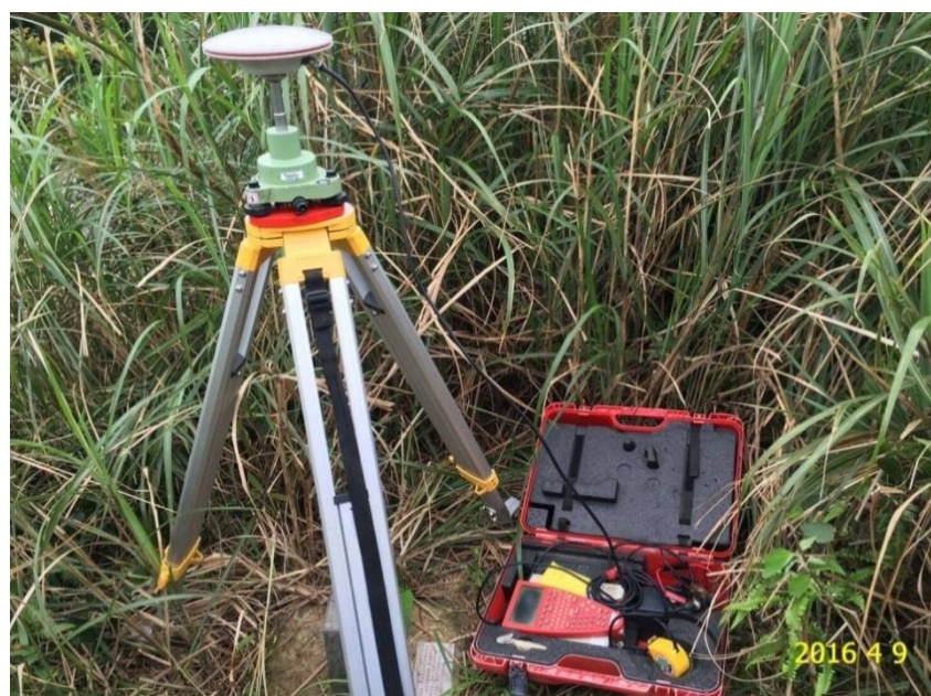
圖 3-2 監測區控制點測量圖
