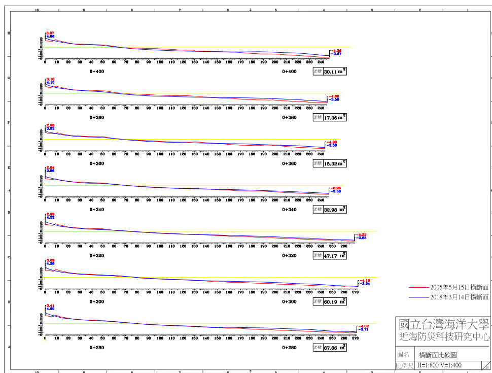
圖 4-5(d) 2018 年 3 月 14 日 B 監測區橫斷面比較圖
