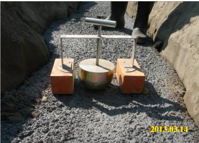
照片 1.1-3 線西區相關產業區自來水管線工程(A10007) CLSM 回填落沉試驗
