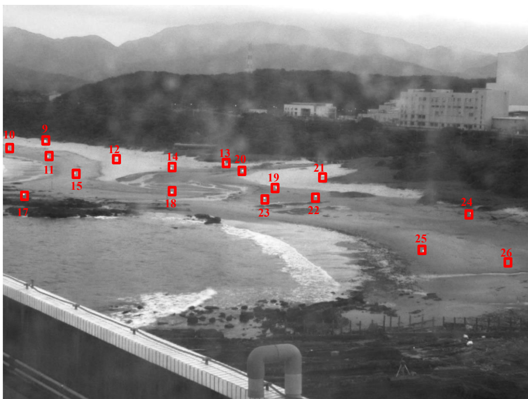
圖 3-21 視角 1(Cam1)地面控制點位置分佈圖例
