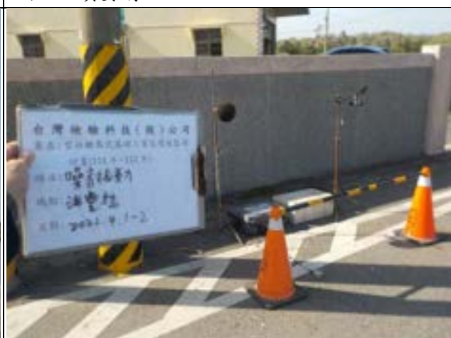
項目：噪音振動 時間：111.4.1~2 地點：海豐橋
