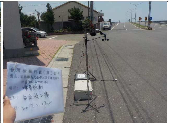
項目：噪音振動 時間：108.04.29~30 地點：台西海口橋
