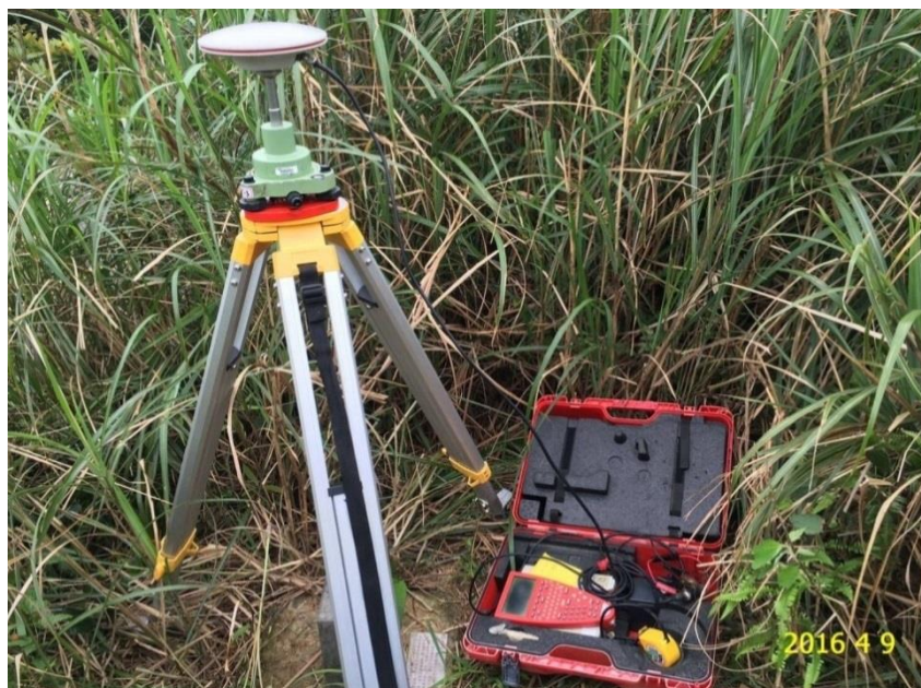
圖 3-2 監測區控制點測量圖
