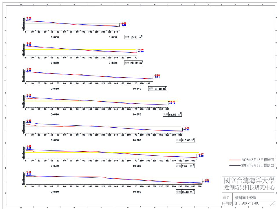
圖 4-5(b) 2019 年 8 月 17 日 B 監測區橫斷面比較圖
