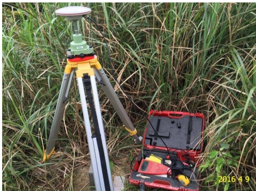
圖 3-2 監測區控制點測量圖
