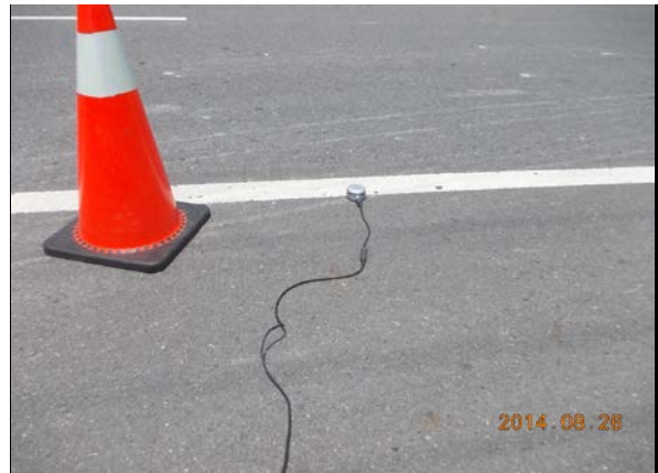
海豐橋(振動監測情形)
