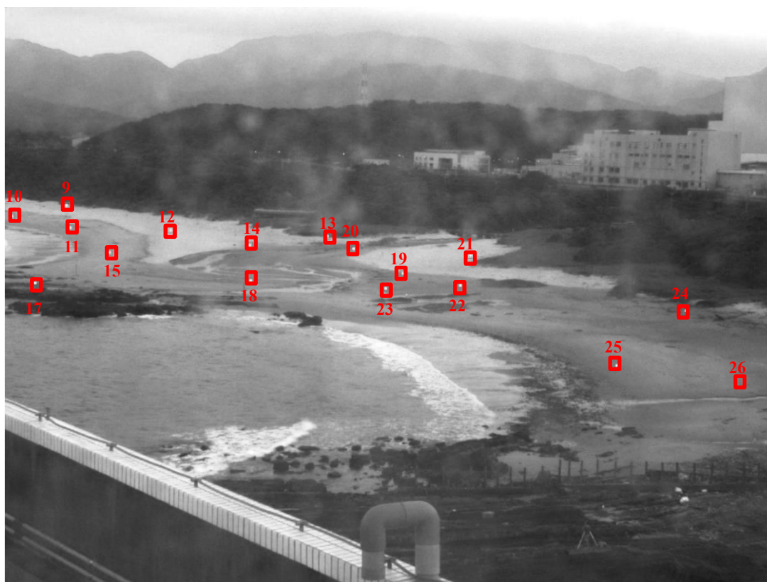
圖 3-21 視角 1(Cam1)地面控制點位置分佈圖例
