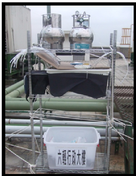
圖 1.12 六輕行政大樓逸散性氣體採樣情形
