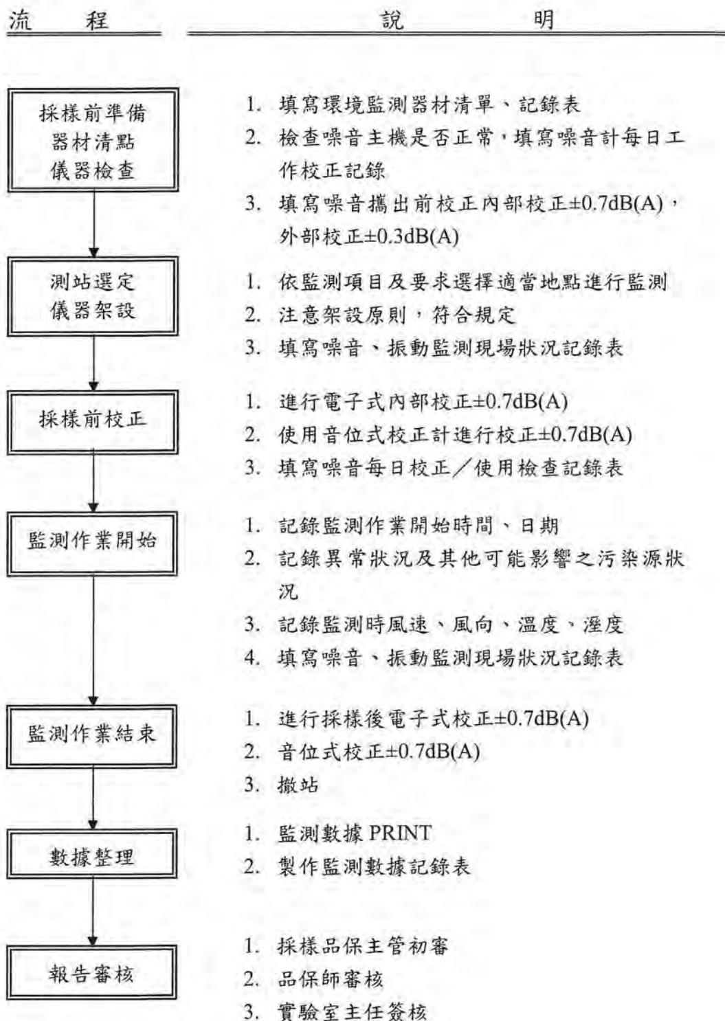
圖 1-2 噪音監測現場作業品保流程圖
