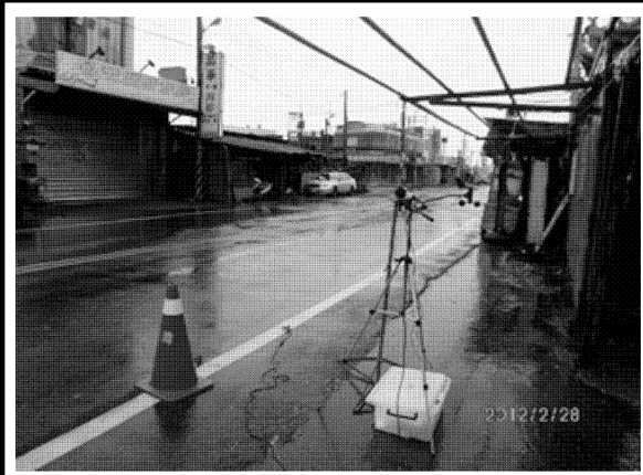
安西府(噪音監測情形)
