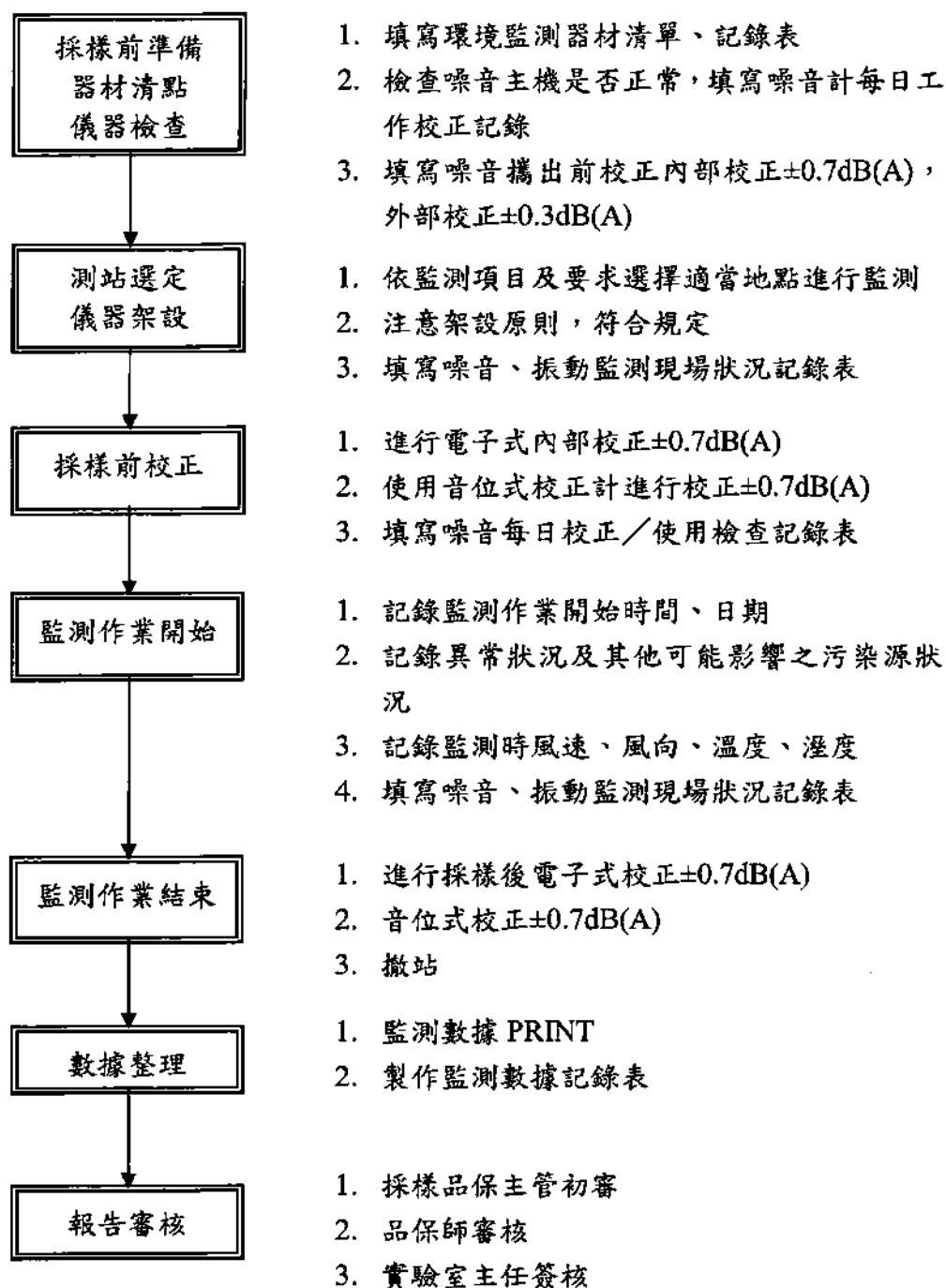
圖 1-2 噪音監測現場作業品保流程圖
