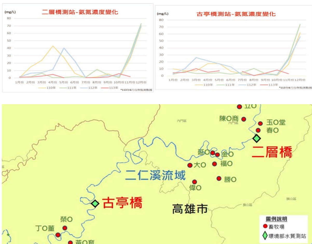
圖 53：上：二仁溪二層橋與古亭橋測站水中氨氮改善情形。下：二仁溪畜牧場分布與水質測站位置圖。
