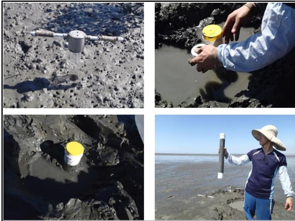
圖 III.6-28 永安水道測站 50cm 底土採樣過程。
