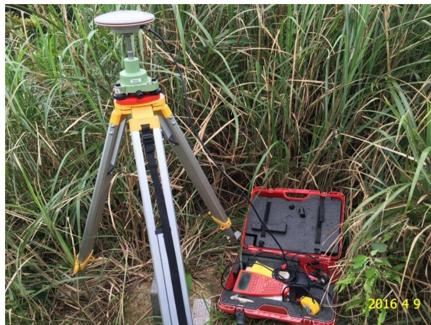
圖 3-2 監測區控制點測量圖
