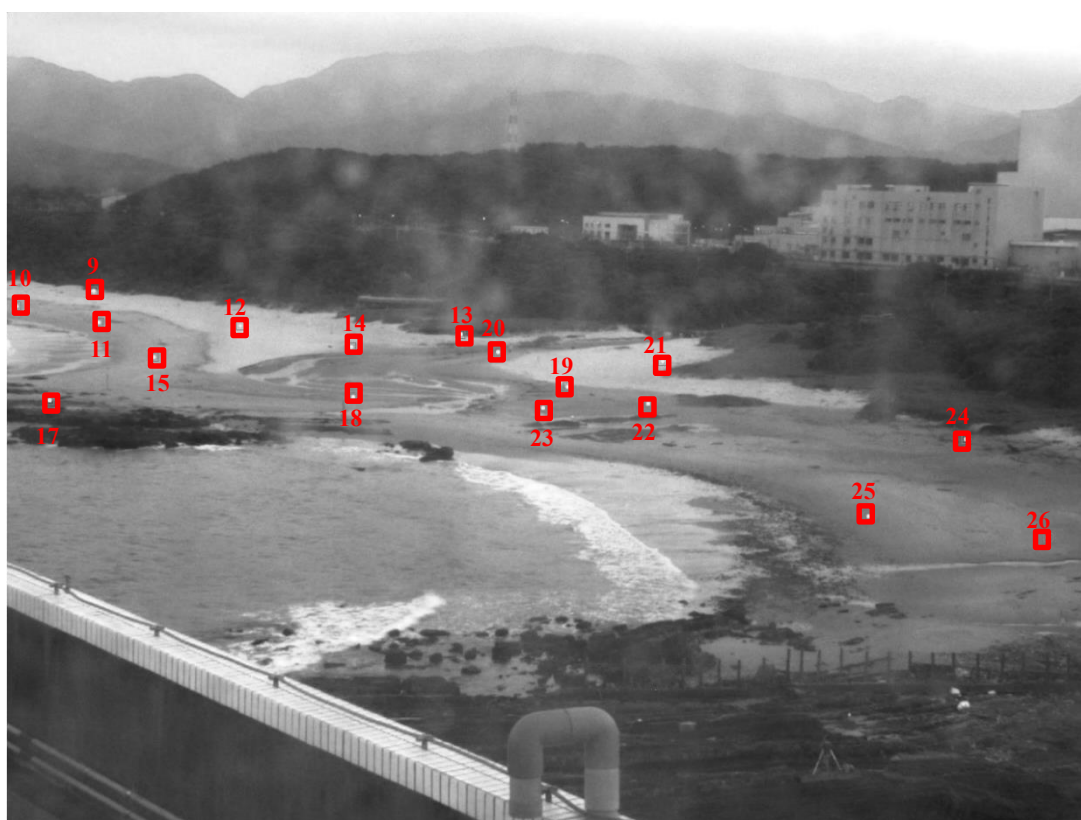
圖 3-21 視角 1(Cam1)地面控制點位置分佈圖例
