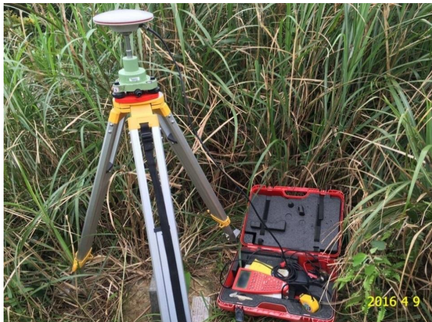
圖 3-2 監測區控制點測量圖
