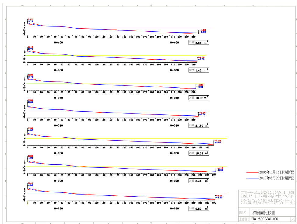
圖 4-5(d) 2017 年 8 月 29 日 B 監測區橫斷面比較圖
