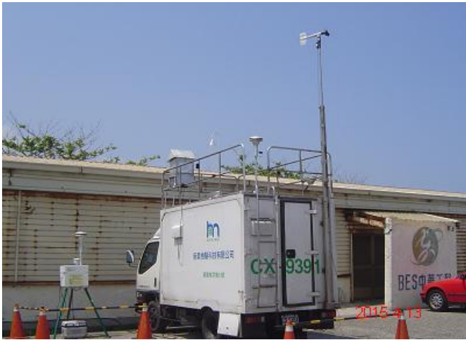
照片 1.3-1 線工南一路空氣品質測站
