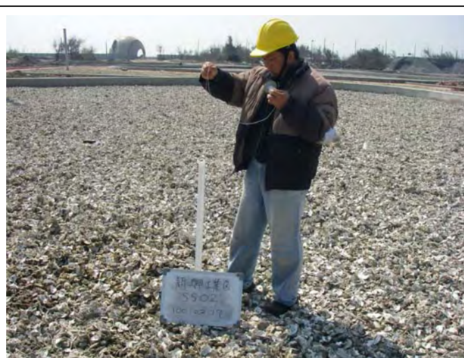
SS02(貝勒管取水)
