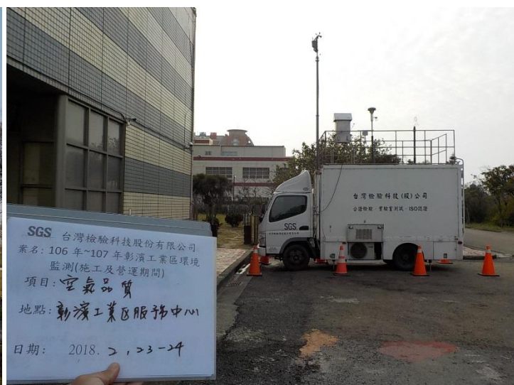
照片 1.3-6 工業區服務中心空氣品質測站
