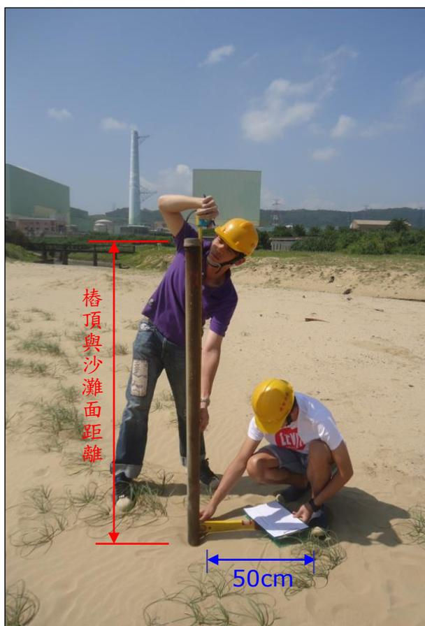
圖 3-13 輔助樁沙灘監測作業情形圖
