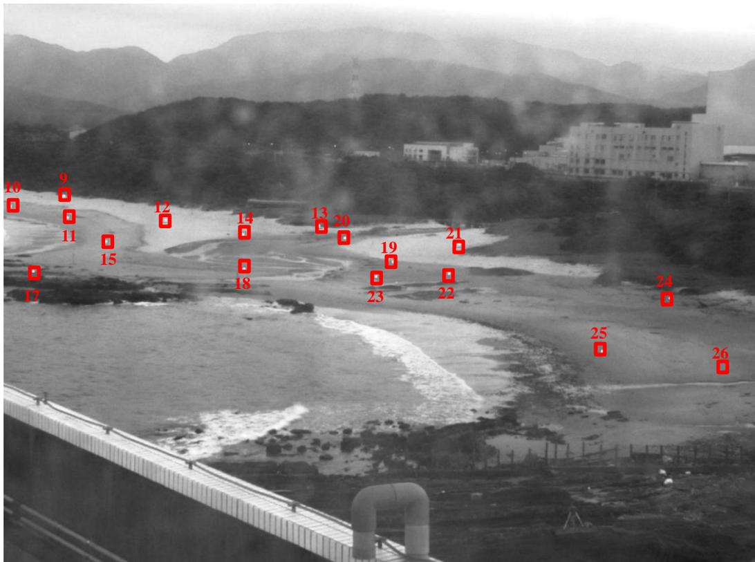
圖 3-21 視角 1(Cam1)地面控制點位置分佈圖例(2016/05/12)
