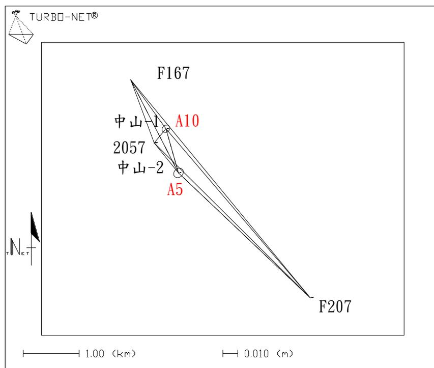
圖 3-1 監測區附近控制點測量範圍圖
