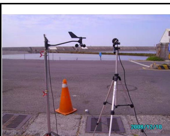
台西海口橋(噪音監測情形)
