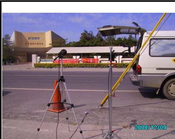
崙豐國小(噪音監測情形)
