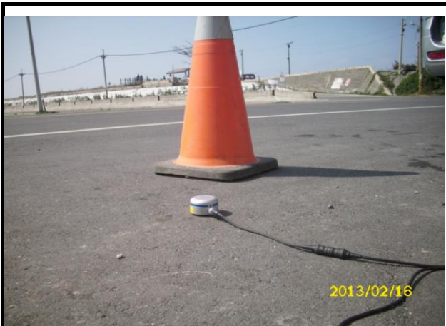
五條港出入管制站(振動監測情形)
