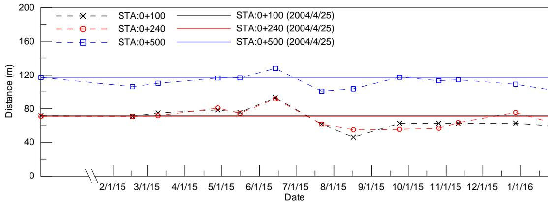
圖 4-16 海岸線断面沙灘寬度變化圖(断面編號：0+100、0+240、0+500)
