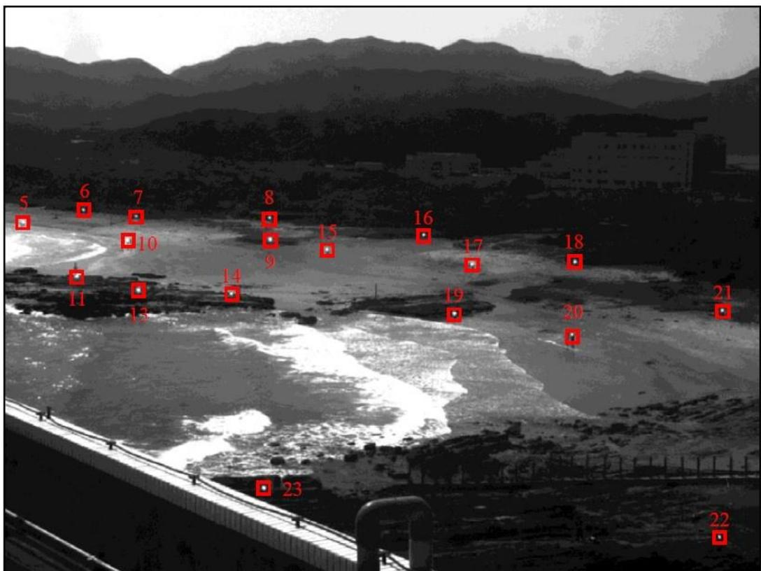
圖 3-21 視角 1(Cam1)地面控制點位置分佈圖例(2013/10/28)
