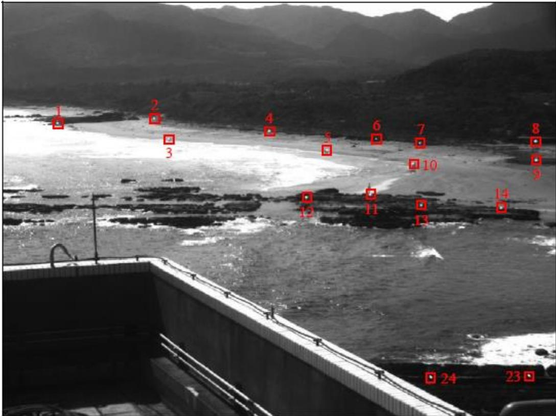
圖 3-20 視角 2(Cam2)地面控制點位置分佈圖例(2013/10/28)
