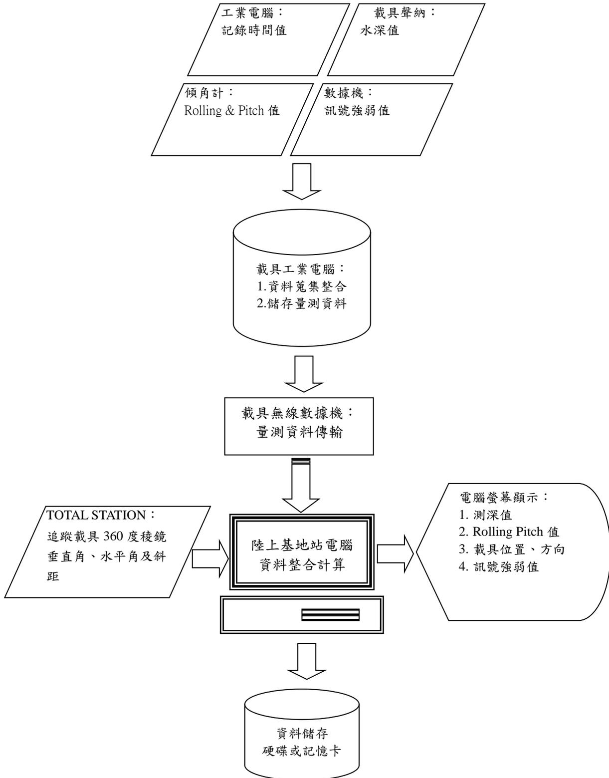
圖 3-4 量測系統資料處理流程圖
