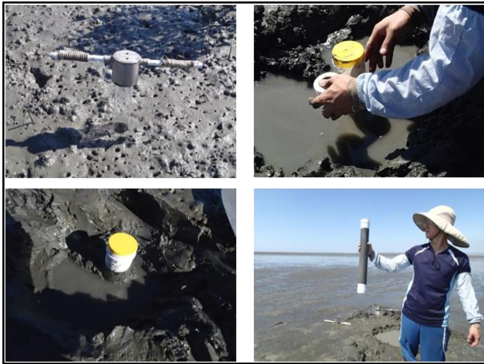
圖 III.6-28 永安水道測站 50cm 底土採樣過程。
