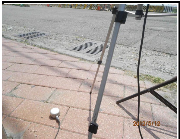
台西海口橋(振動監測情形)
