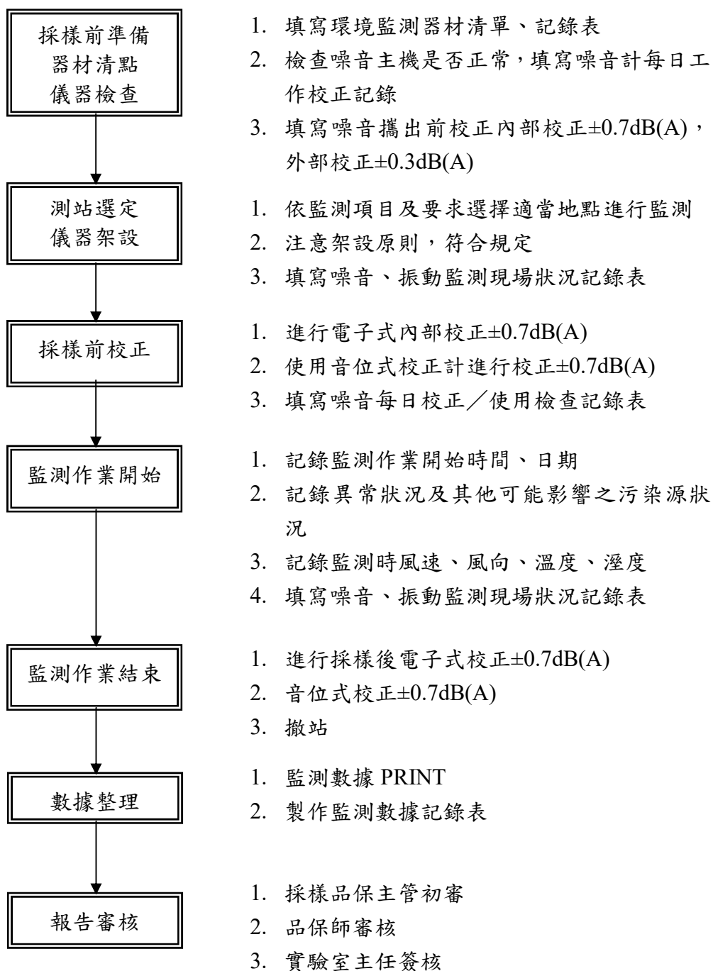
圖 1-2 噪音監測現場作業品保流程圖
