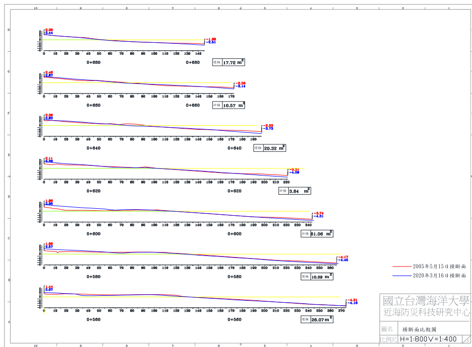
圖 4-5(b) 2020 年 3 月 16 日 B 監測區橫斷面比較圖
