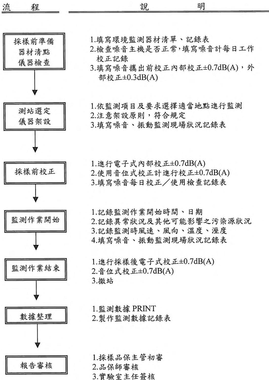
圖 1-2 噪音監測現場作業品保流程圖
