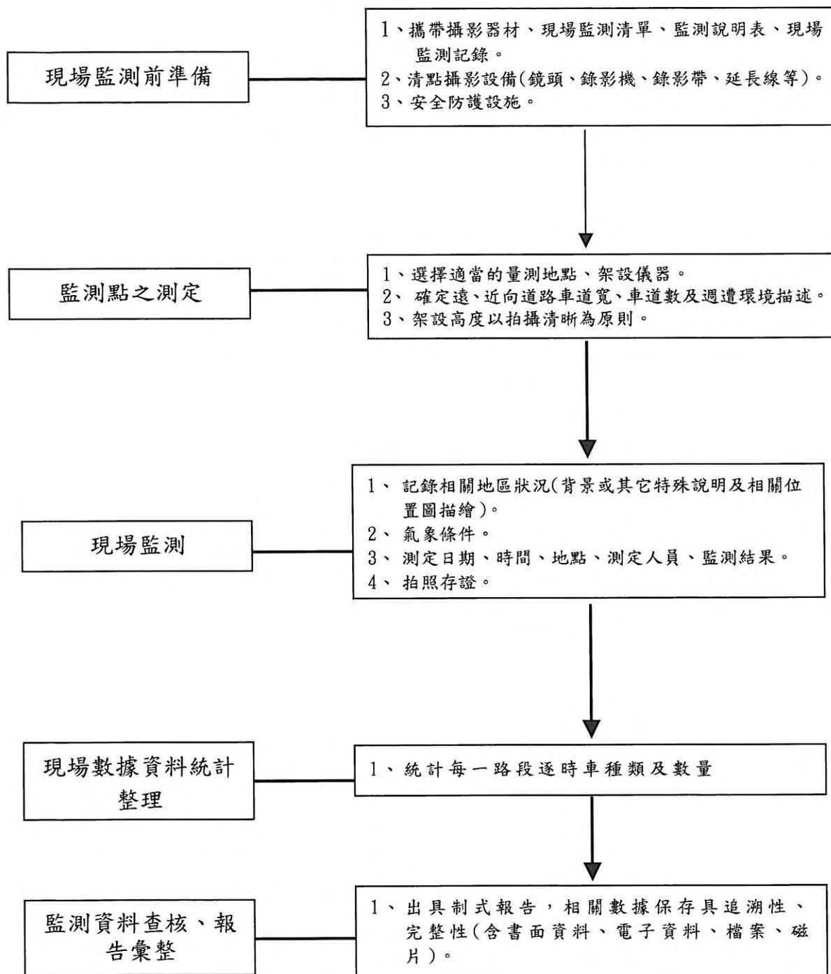
圖 1-4 交通量監測分析流程圖
