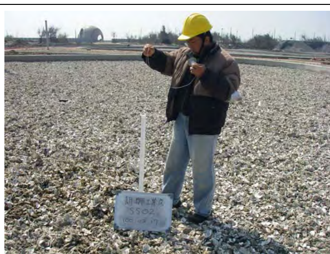
SS02(貝勒管取水)
