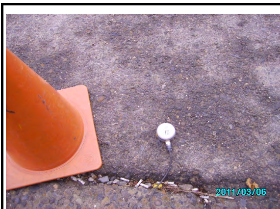
台西海口橋(振動監測情形)
