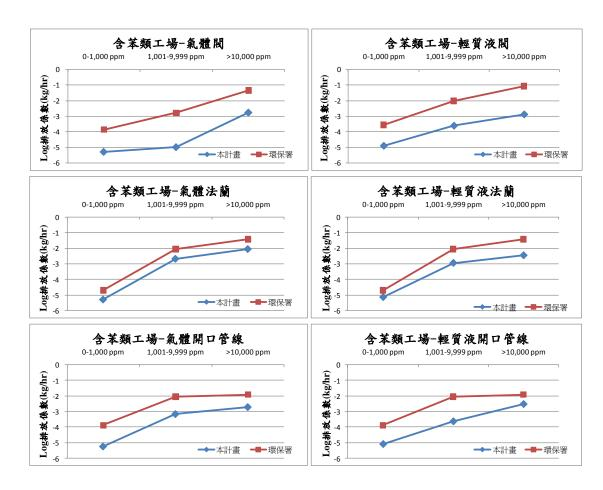
圖3.4-2 含苯類工場設備元件排放係數與環保署係數比較圖
