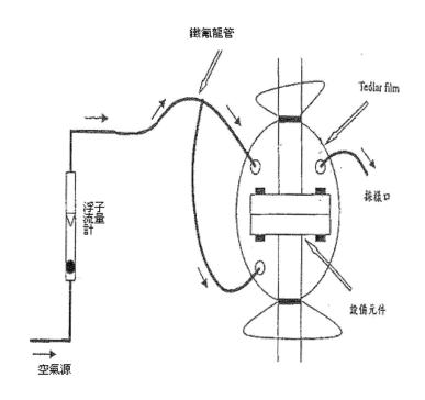
圖2.2-1 設備元件圍封法採樣方式
