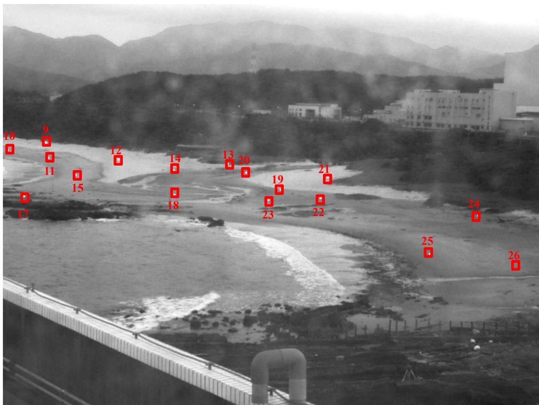
圖 3-21 視角 1(Cam1)地面控制點位置分佈圖例(2016/05/12)
