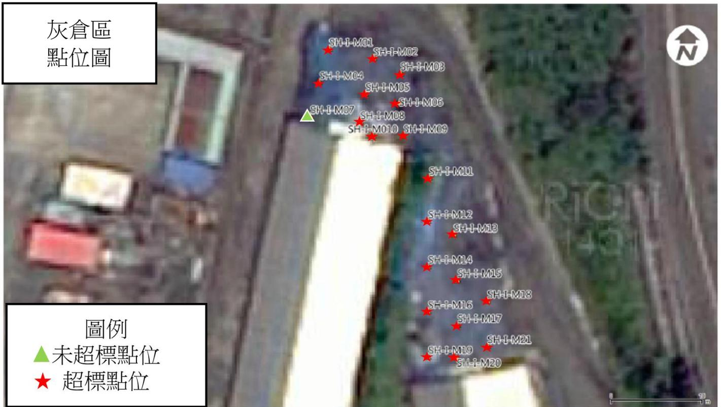
圖 7 灰倉區超標點位示意圖 (資料來源：台電公司)
