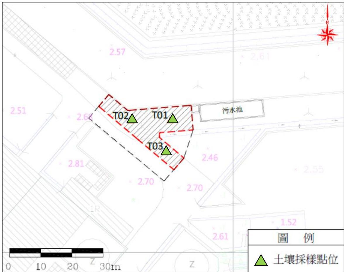
圖 9 廢鐵區改善後驗證土壤採樣點位置示意圖 (資料來源：台電公司)
