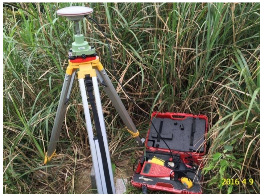
圖 3-2 監測區控制點測量圖
