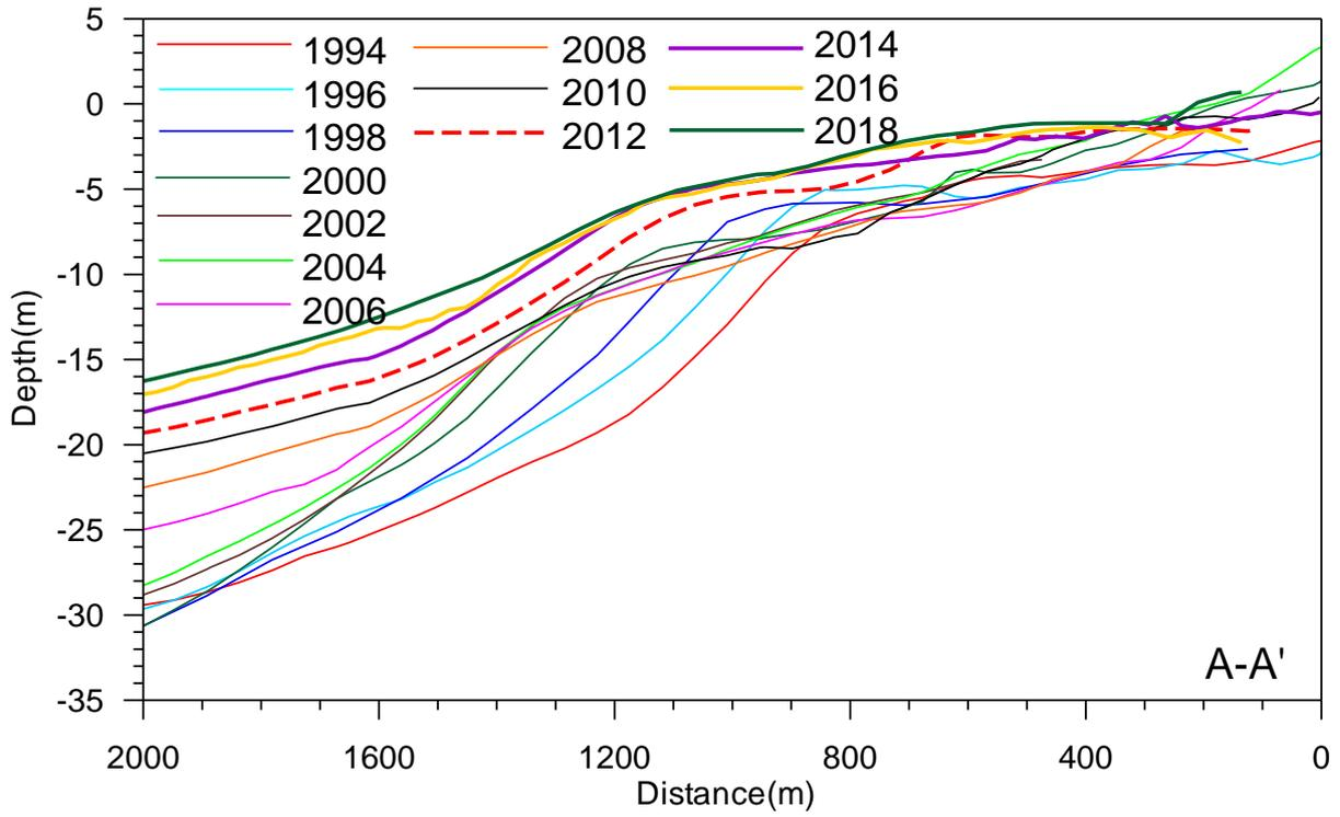
圖 3.1.12-35A 地形測量斷面比較圖(A-A')
