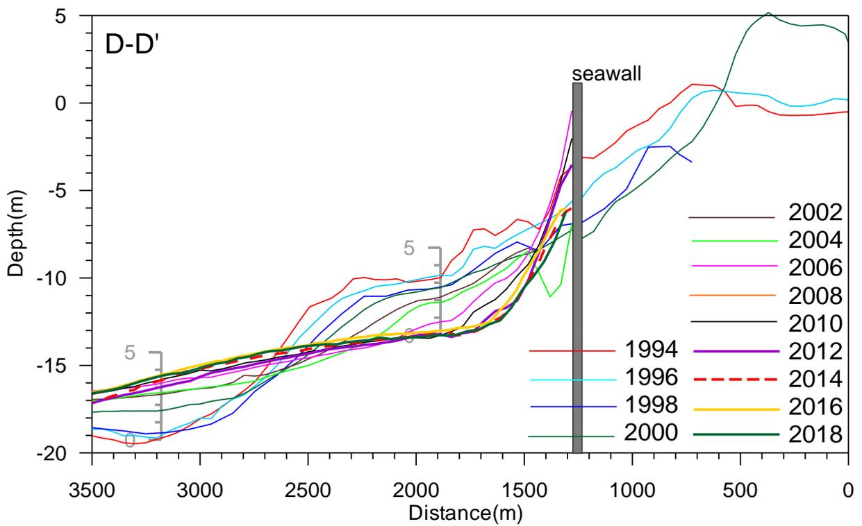
圖 3.1.12-35D 地形測量斷面比較圖(D-D')
