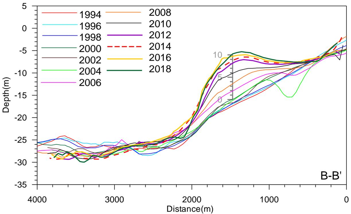
圖 3.1.12-35B 地形測量斷面比較圖(B-B')
