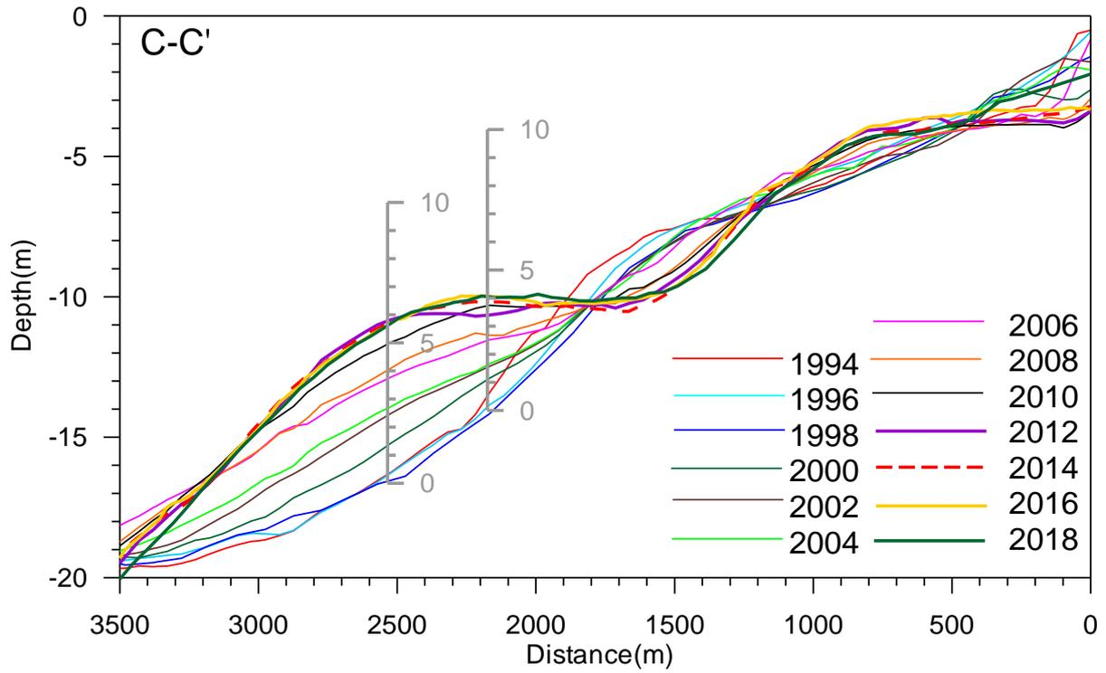
圖 3.1.12-35C 地形測量斷面比較圖(C-C')
