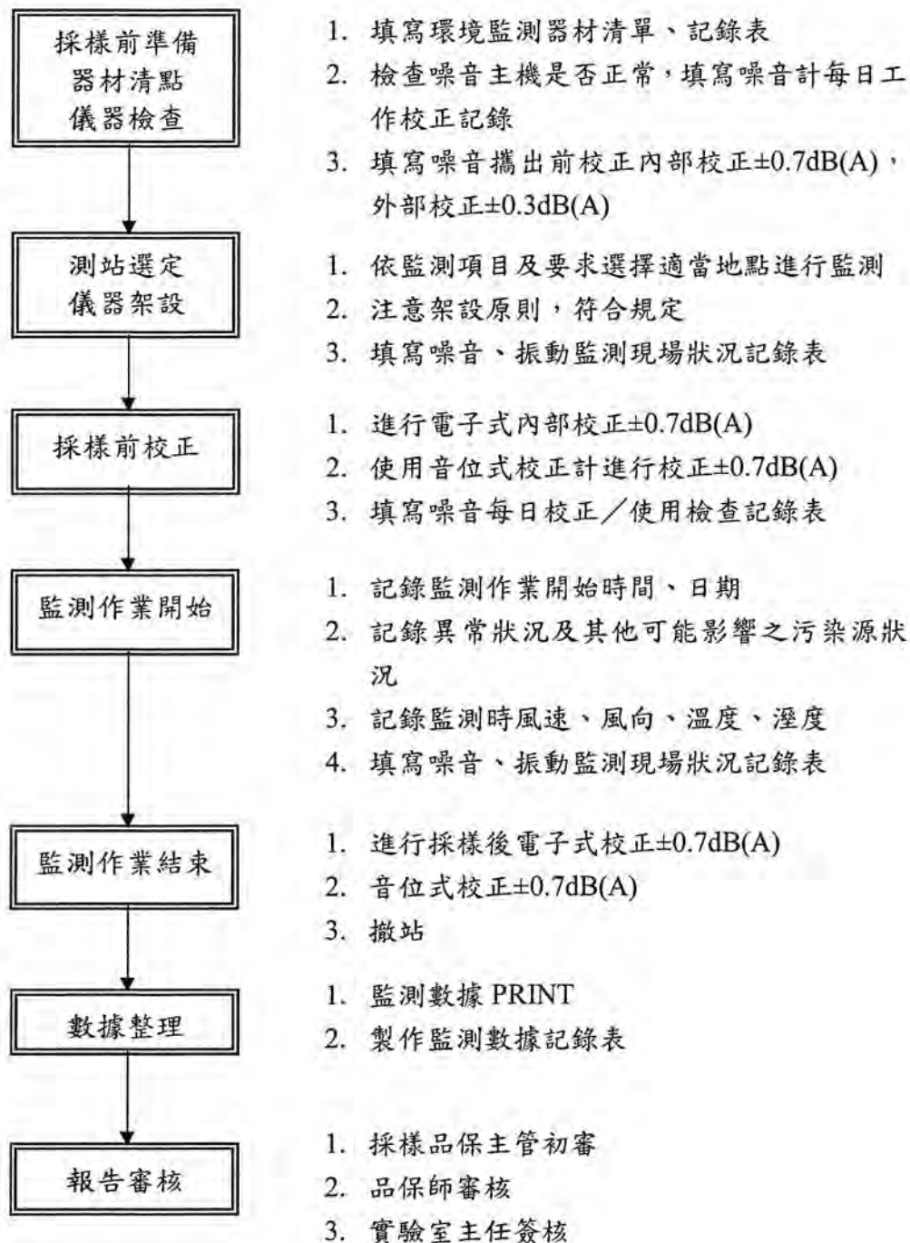
圖 1-2 噪音監測現場作業品保流程圖
