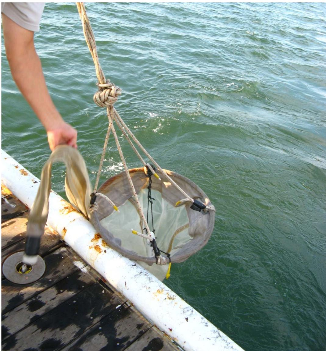
1. 採用北太平洋標準浮游生物網（網口直徑45cm，網目 $333\mu\text{m}$ ，網身長180cm）進行水平拖曳採集5~10分鐘，網口中央繫有流速計以計算通過網口水量。
