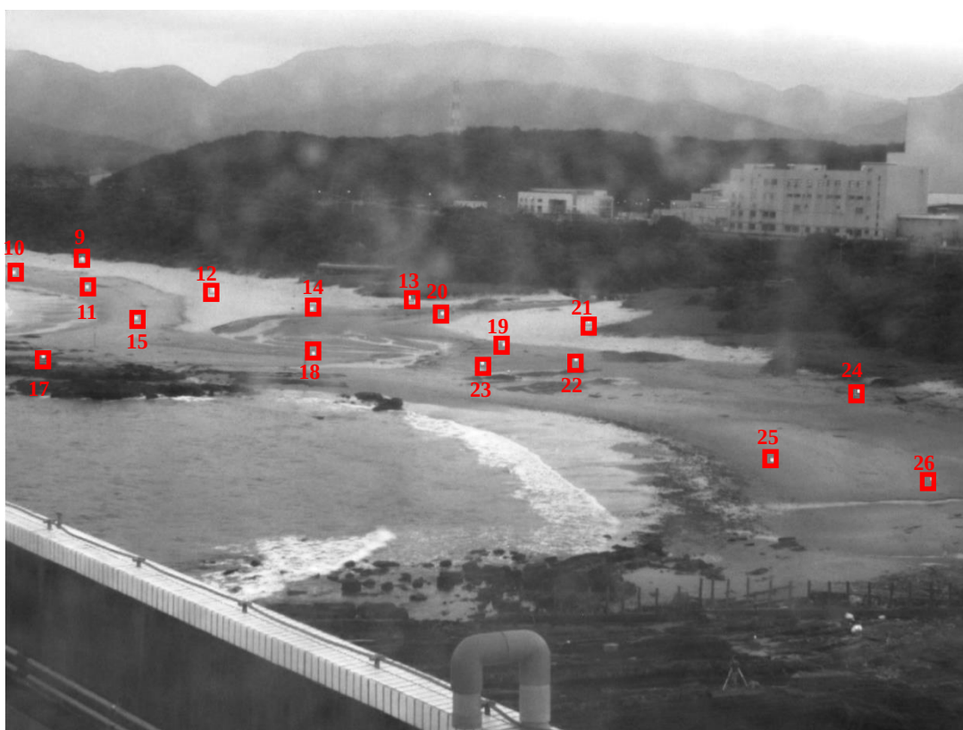
圖 3-21 視角 1(Cam1)地面控制點位置分佈圖例(2016/05/12)
