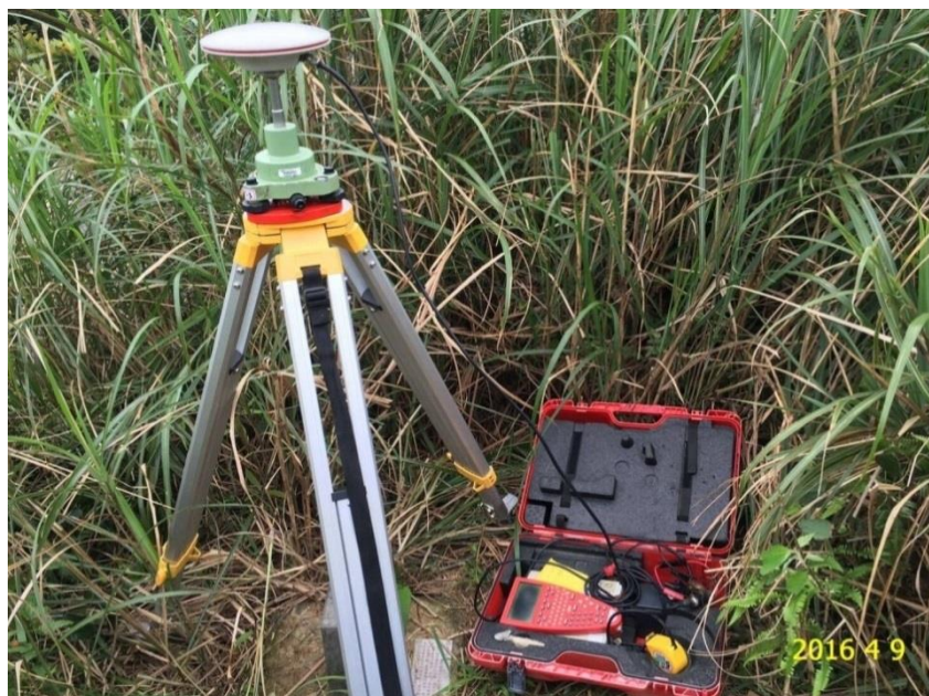
圖 3-2 監測區控制點測量圖
