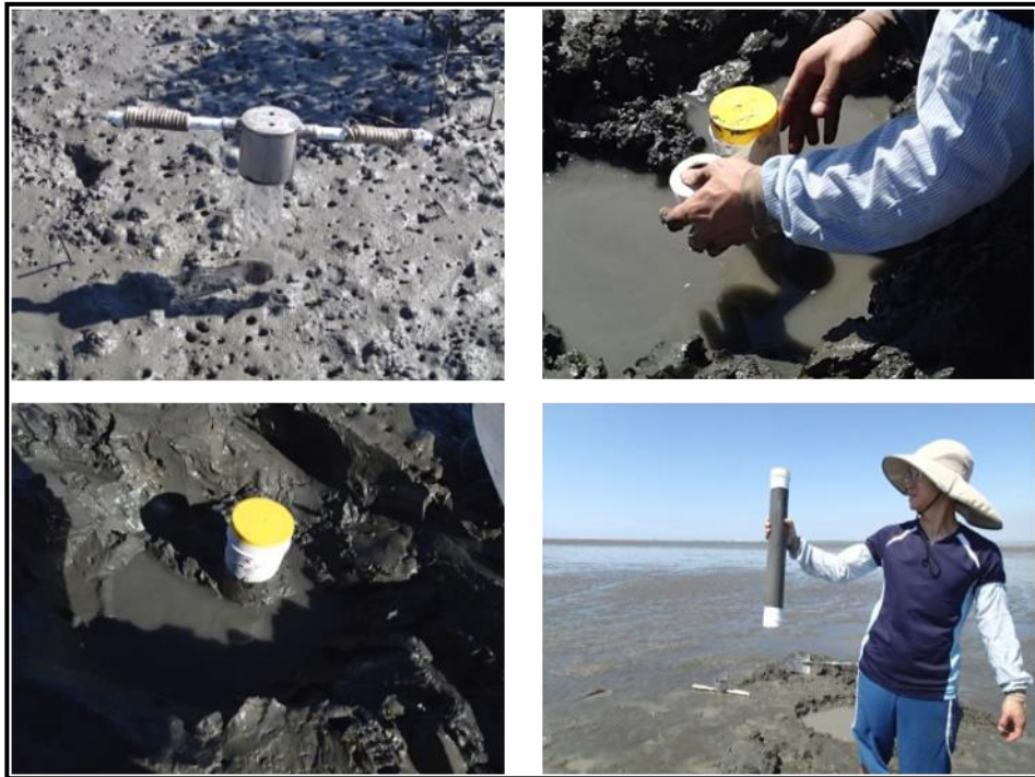
圖 III.6-28 永安水道測站 50cm 底土採樣過程。
