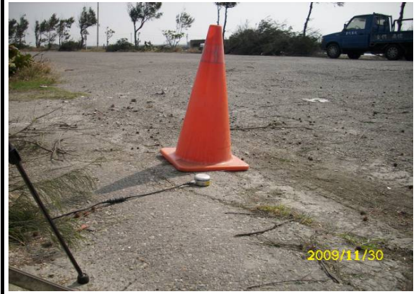
五條港出入管制站(振動監測情形)
