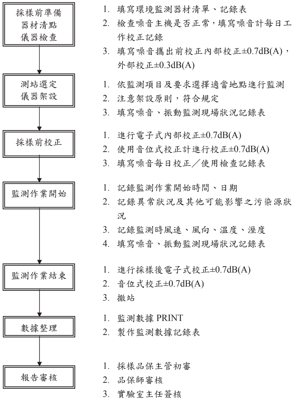
圖 1-2 噪音監測現場作業品保流程圖
