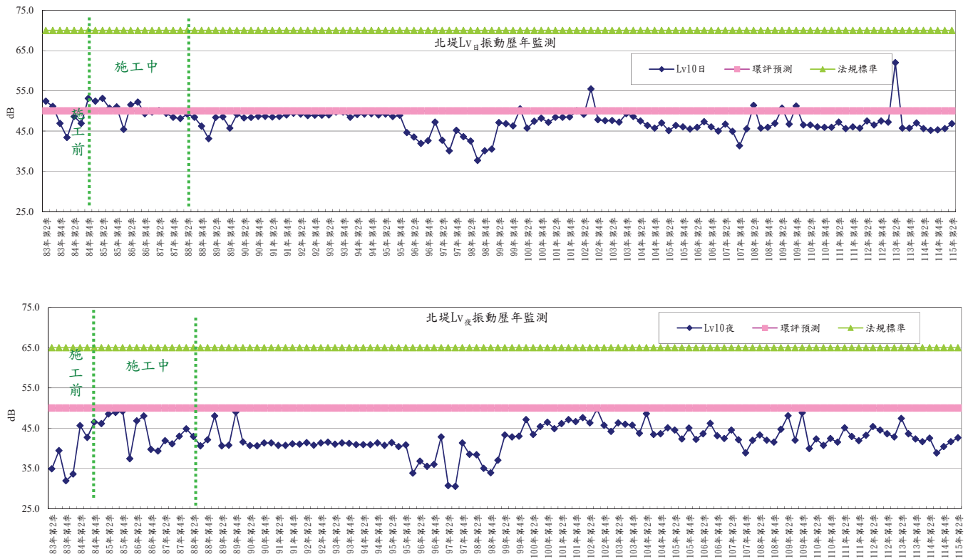
圖3-37 北堤測點振動歷年監測變化趨勢圖
