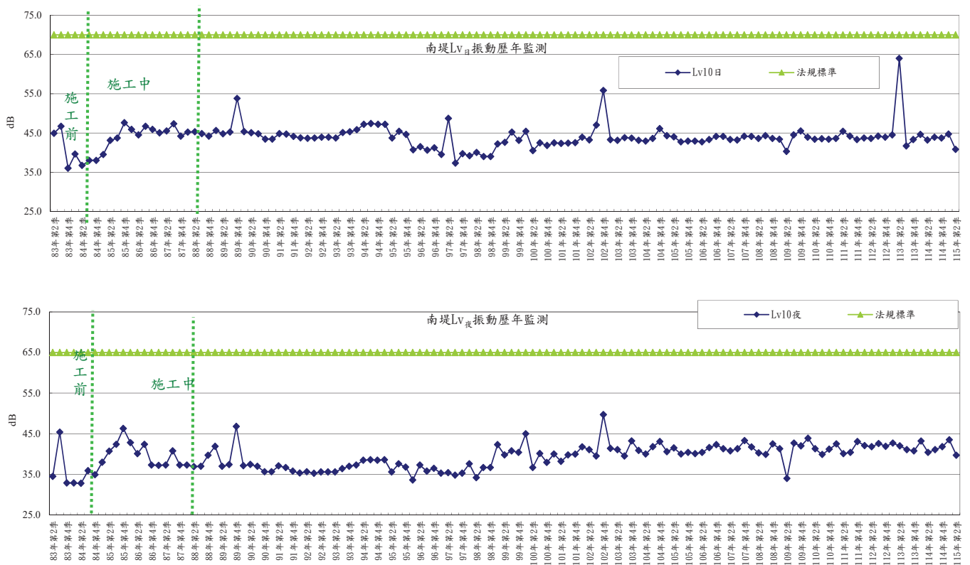
圖3-38 南堤測點振動歷年監測變化趨勢圖
