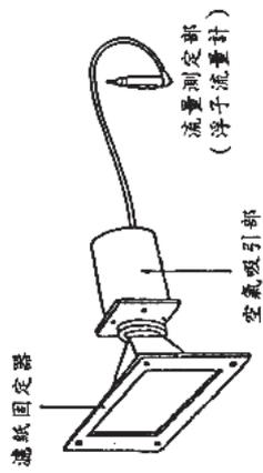
圖一 高量空氣採樣器之構造例
