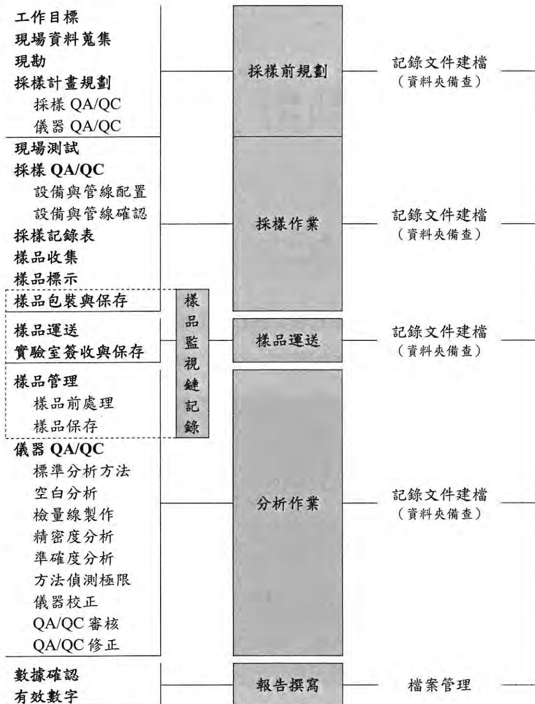
採樣分析之品保/品管作業流程
