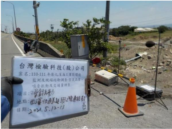
照片 1.3-7 噪音振動交通量測站 1
