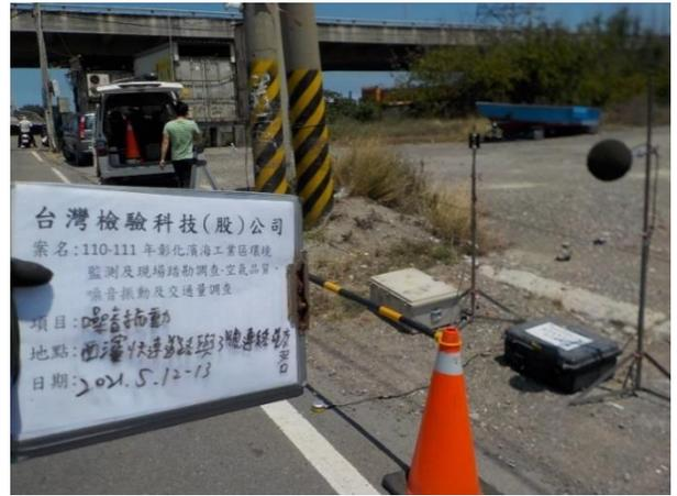
照片 1.3-8 噪音振動交通量測站 2
