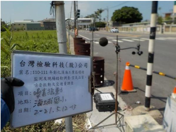
照片 1.3-9 噪音振動交通量測站 3
